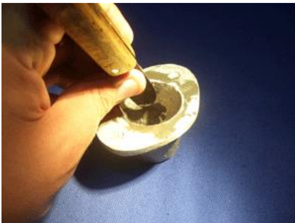
Fig. 14. Limpieza del colado.
