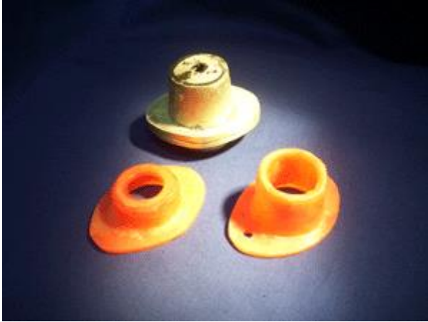
Fig. 15. El método seleccionado permitió la recuperación íntegra de la escultura de cera. Nótese la rebaba en la abertura de la Contraparte, que se debe al inevitable corrimiento del metal entre el molde interno y el externo.
