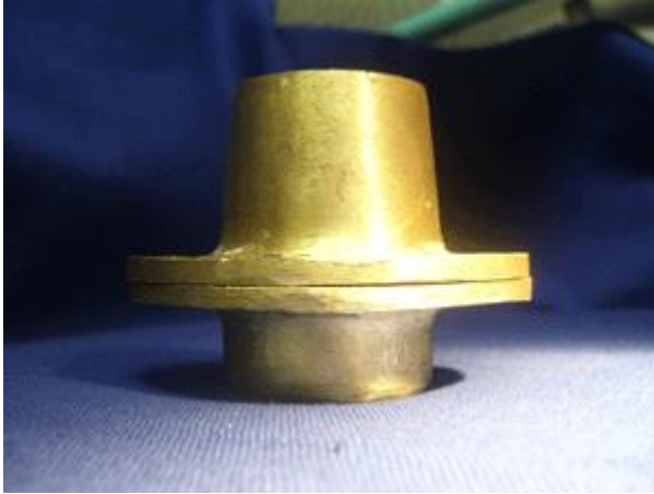
Fig. 19. Logro de un asiento satisfactorio entre Parte y Contraparte.
