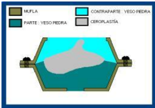
Esquema 1. Corte vertical de la puesta en mufla de un conformador orbitario con mango.
