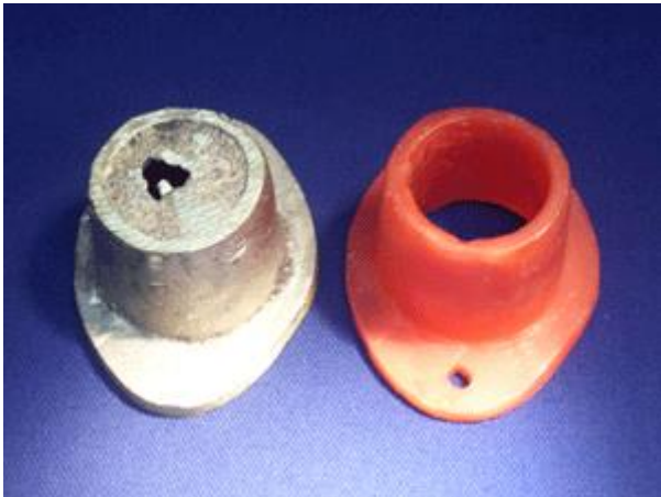
Fig. 16 A. Contraparte colada con rebaba y la cera correspondiente
