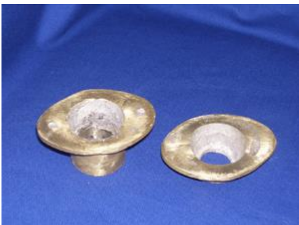
Fig. 18 B. Las cavidades útiles deben ser igualmente mecanizadas, nótese las superficies planas de asiento, logradas.
