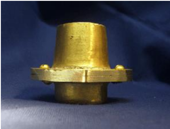
Fig. 22. Mufla cerrada, nótase los “tornillos pino” y tornillos de fijación. Guía superior tallada.
