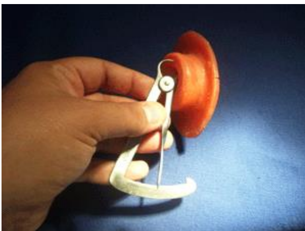
Fig. 10. Parte con perforación en su base, siendo calibrada por el operador para obtener el espesor mínimo necesario.
