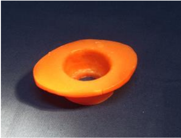
Fig. 11. Escultura de la parte terminada, se suaviza con agregado por goteo de cera la unión entre el piso y las paredes laterales del cilindro.
