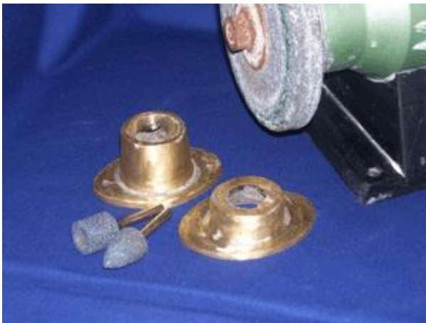
Fig. 18 A. Se hace un recorte mediante la utilización de piedras como se ilustran en la imagen, distintas formas rueda, cilíndrica, y pimpollo.
