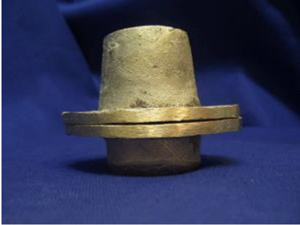
Fig. 17. Colados relacionados entre sí, nótese la "luz" entre la Parte y la Contraparte.
