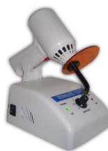
una lámpara que contiene el gas de xenón y dos electrodos. Por no contener filamento, este sistema utiliza una corriente eléctrica para producir un arco de luz entre los electrodos a través de la ionización del gas de xenón circundante para formar un plasma. En estas lámparas la intensidad luminosa puede alcanzar hasta  $2400 \text{ mW/cm}^2$ , con un espectro de longitud de onda ente 380 y 500 nm.
