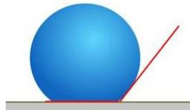
Representación esquemática de un líquido con alta tensión superficial y/o un sólido con baja energía superficial, formando un ángulo de contacto mayor o igual a 90 grados.
