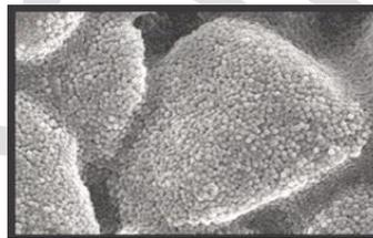
Imagen a través de un Microscopio Electrónico de Barrido que ilustra la disposición de partículas en un Nanocluster.
